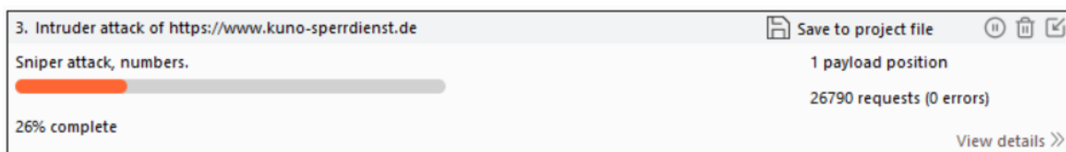
Abbildung 10: Laufende Abfrage der Sperrbestätigungsnummern innerhalb von Burp Suite Intruder
